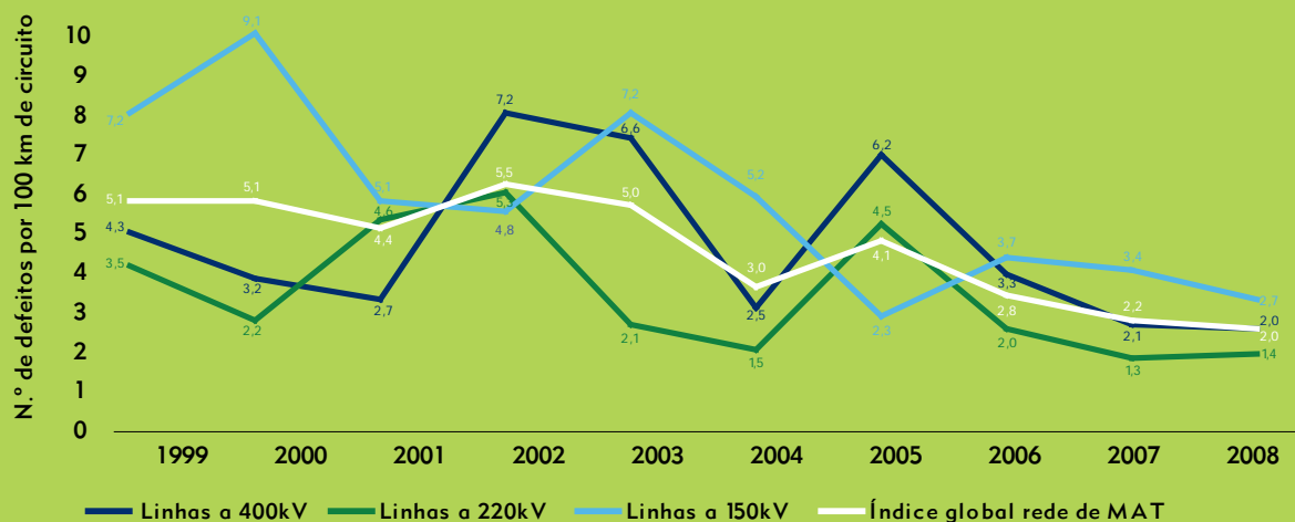
Evolução do número de defeitos com origem em linhas da RTN por 100 km de circuito
